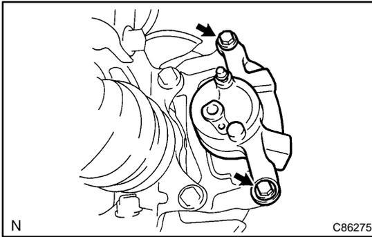
**29. INSTALL FRONT DISC BRAKE CYLINDER SUB-ASSY**
