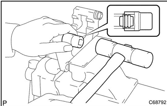
**24. INSTALL FRONT DISC BRAKE BUSH DUST BOOT**
