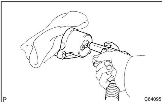
**10. REMOVE FRONT DISC BRAKE PISTON**
