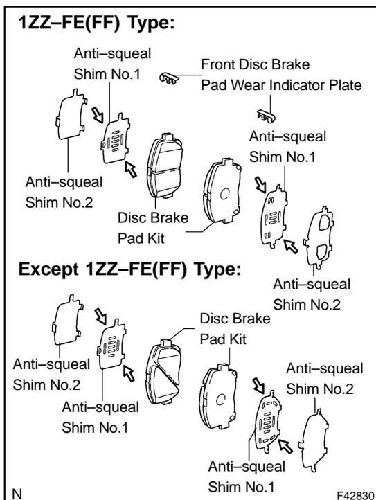
**28. INSTALL DISC BRAKE PAD KIT FRONT (PAD ONLY)****NOTICE:**
